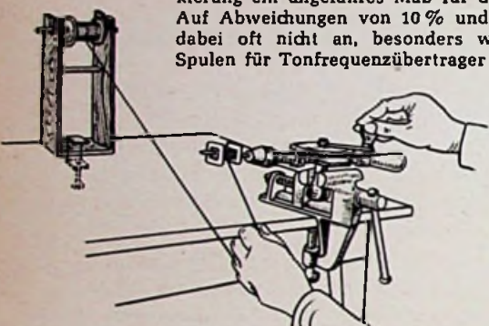
Bild 1. Mit wenig Handgriffen läßt sich diese behelfsmäßige Wickel-einrichtung schaffen
