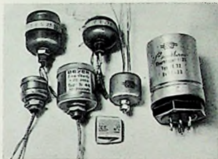
Bild 1. Größenvergleich von hochwertigen Eingangübertragern verschiedener Hersteller mit einem Sahnebonbon. Die Hersteller der Übertrager sind die Firmen Egon Beyer, Heilbronn/Neckar; Helmut Haufe, Usingen/Taunus; Labor W, Bissendorf/Hannover
